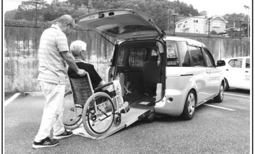
後方のスロープから車椅子ごと乗車し、車に固定します。
